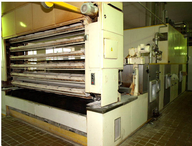
Obr. 9 Průběžná pásová pec s cyklotermickým ohřevem
