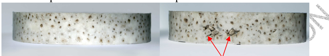
Obr. 4 Vzorek č. 53 (vlevo) bez porušené povrchové struktury a vzorek č. 44 (vpravo) s porušenou strukturou povrchu
