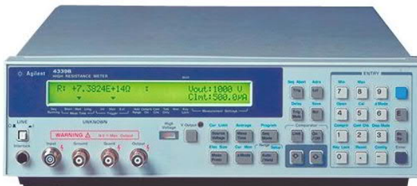
Obr. 30: Měřicí přístroj Agilent 4339B High Resistance Meter [35]
