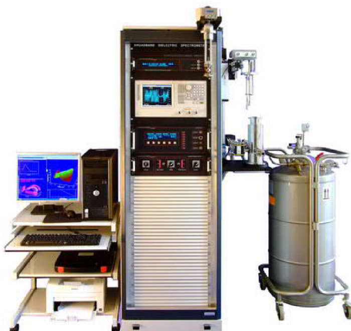
Obr. 29: Měřicí sestava s širokopásmovým impedančním analyzátozem Novocontrol Technologies [33]
