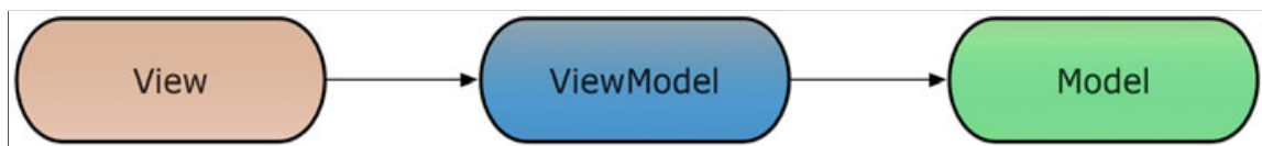
Obr. 3.2: Vzor Model-View-ViewModel (MVVM) [10]
