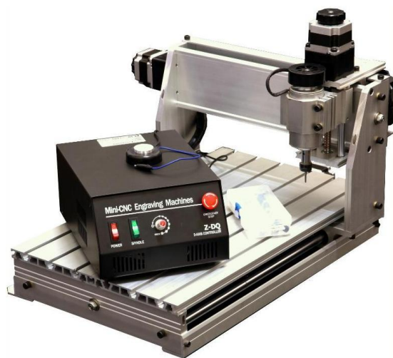
Obr. 2 – Malá modelářská CNC frézka pro gravírování a rytí [1]
