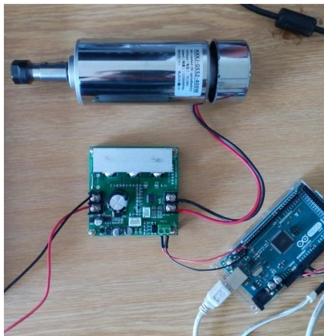
Obr. 70 – Zapojení vřetene k Arduino pomocí zesilovače
