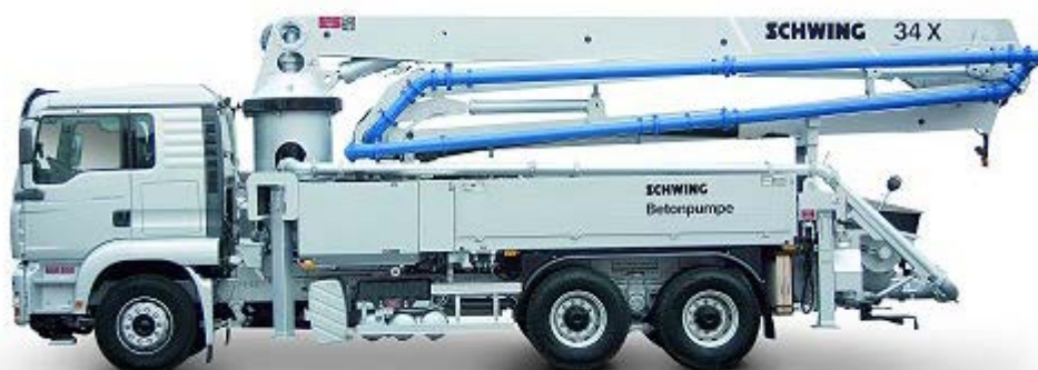
Obr. 7.17 Autočerpadlo SCHWING S 34 X (boční pohled) [40]
