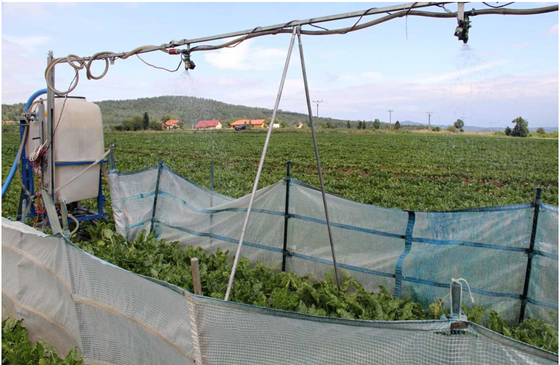
Obrázek č. 2 - Polní simulátor deště
