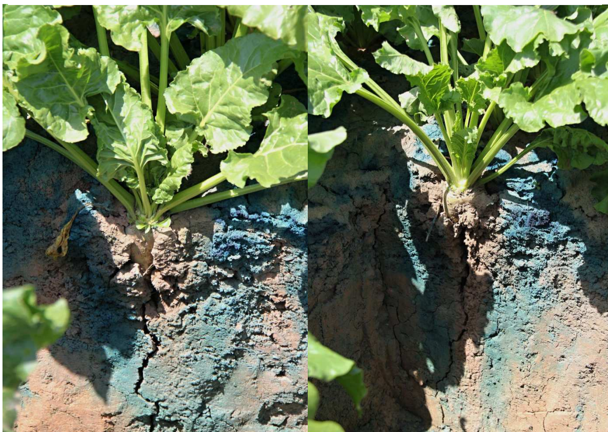
Obrázek č. 3 – Znázornění míry infiltrace za pomoci modrého barviva
