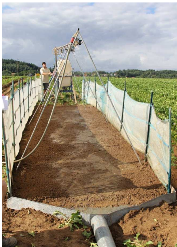
Obrázek č. 4 – Zadešťování na variantě č. 1 (mělké kypření)
