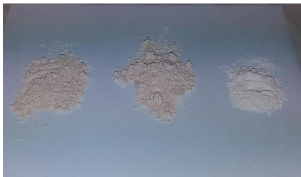
Obrázek 16: Bělost vypáleného kaolinu obsahující jemnou frakci písku (vlevo), střední frakci písku (uprostřed) a hrubou frakci písku (vpravo).
