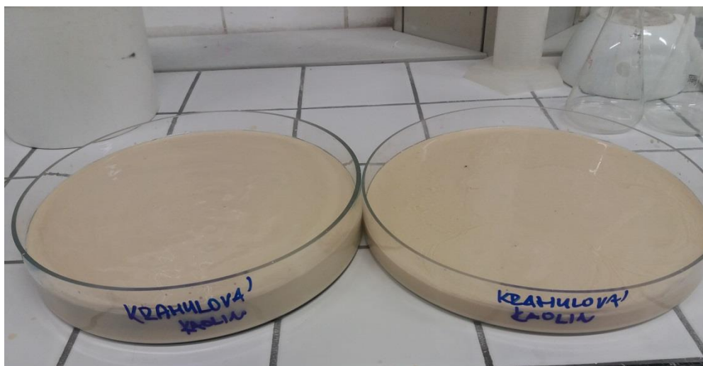
Obrázek 9: Rozplavená kaolinová suspenze před vložením do sušárny.
