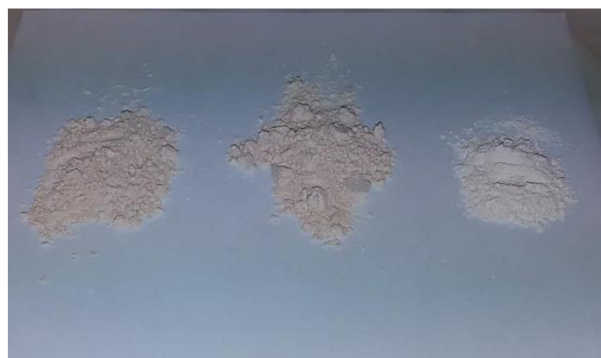
Obrázek 16: Bělost vypáleného kaolinu obsahující jemnou frakci písku (vlevo), střední frakci písku (uprostřed) a hrubou frakci písku (vpravo).
