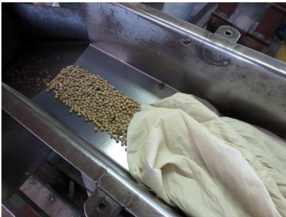
Obr. č. 33: Čištění pelušky na vzduchové čističce zrna Petkus
