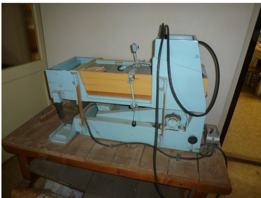
Obr. č. 16: vibrační třídíčka zrna Petkus Fortschritt
