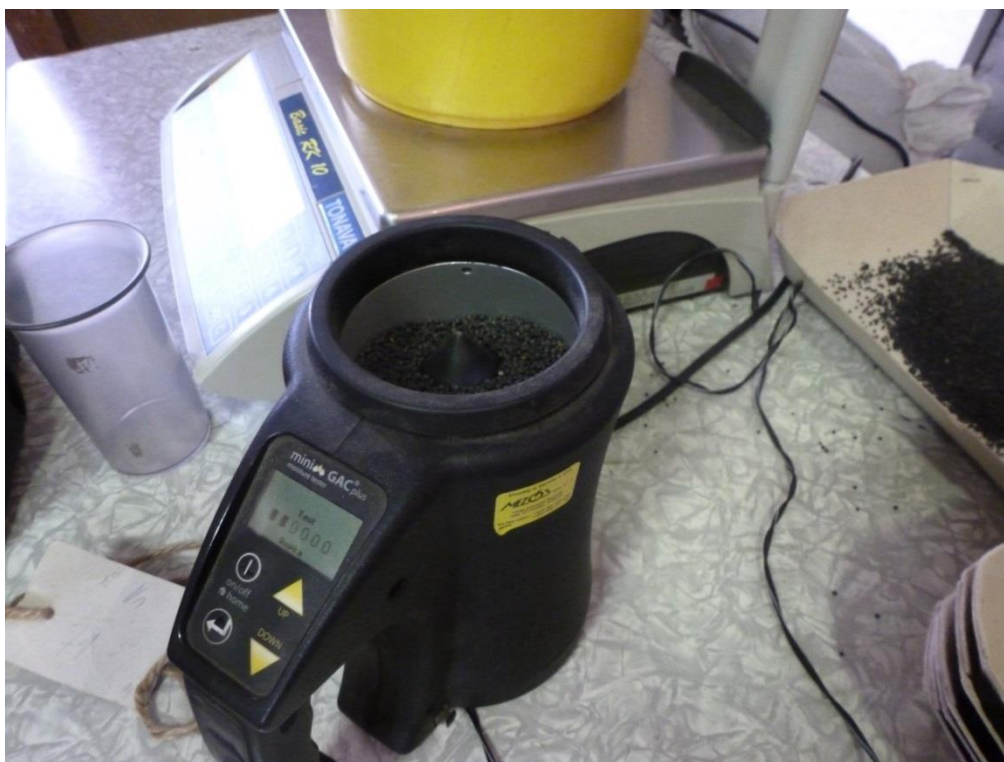
Obr. č. 38: Vlhkoměr Mini GAC plus měřící vlhkost vzorku řepky
