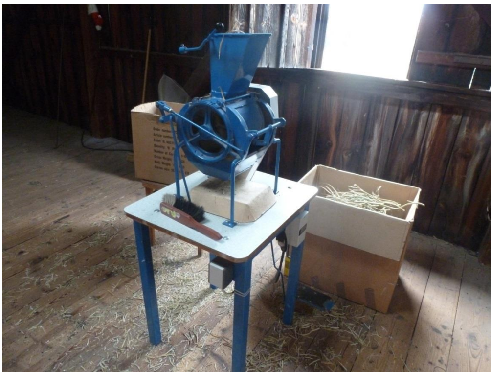
Obr. č. 35: Drhlík osiva (vyrobený svépomocí)
