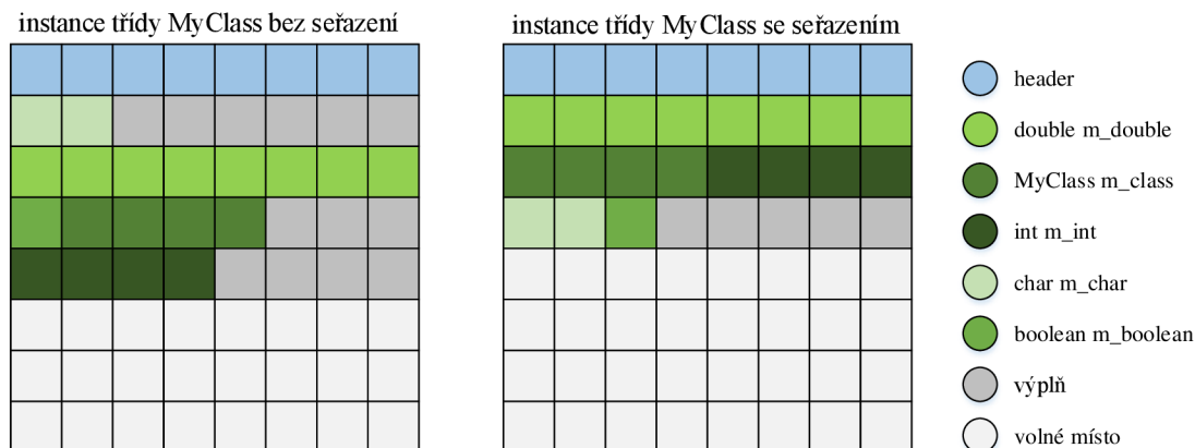
Obrázek 4.1: Instance třídy MyClass s a) neseřazenými a b) seřazenými datovými položkami.
