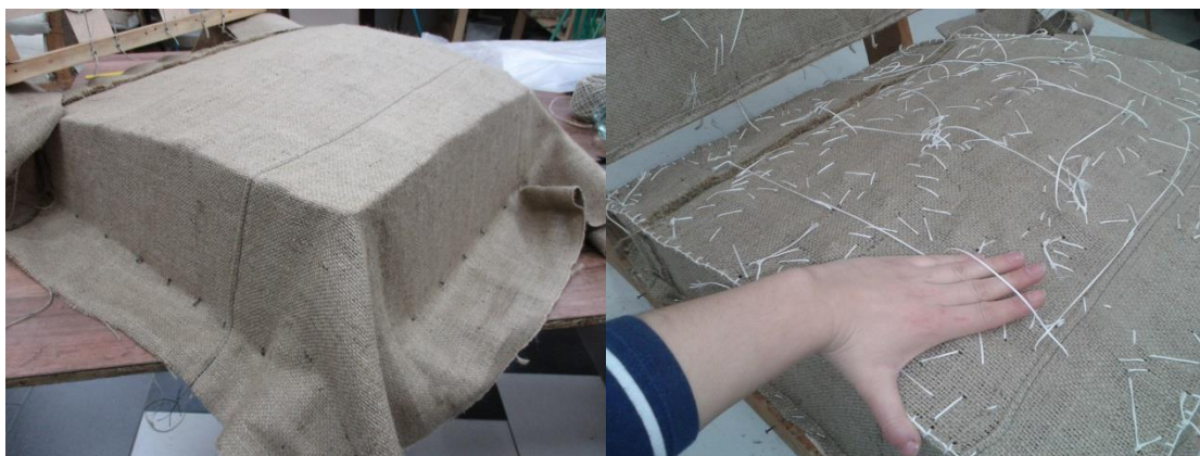
Obr. 22 Přípevnění husté juty
