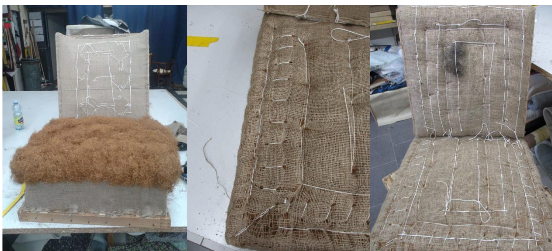
Obr. 23 Tvarovací vrstva a její prošíání
