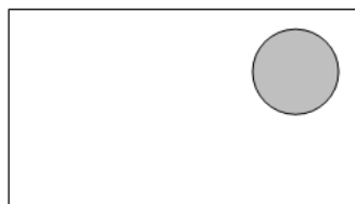
Obr. 22: Nákres testovacího skla (šedá oblast znázorňuje \text{TiO}_2 , bílá FTO vrstvu)
