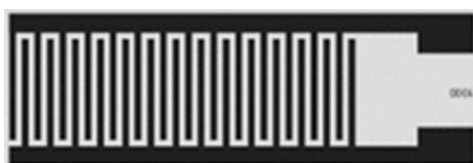
Obr. 5: Schematické znázornění interdigitálního uspořádání elektrochemického článku [14]
