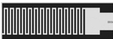
Obr. 5: Schematické znázornění interdigitálního uspořádání elektrochemického článku [14]
