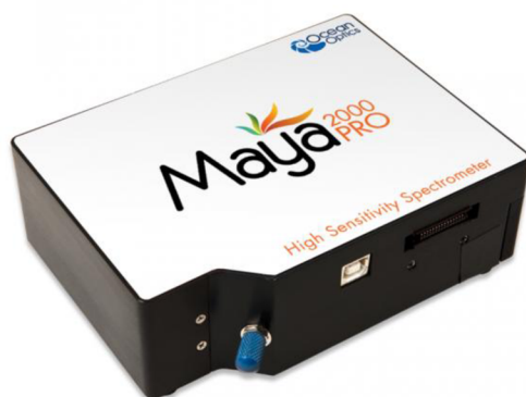
Obr. 10: Vláknový spektrometr Maya Pro [44]
