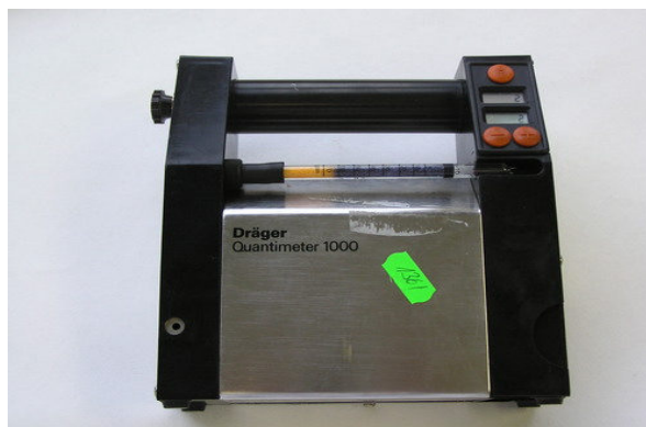
Obrázek číslo 8: Bateriový nasavač Dräger Quantimeter 1000 [13]
