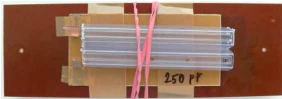
Pobr. 27 Snímek kondenzátoru pro testování dielektrika FR2
