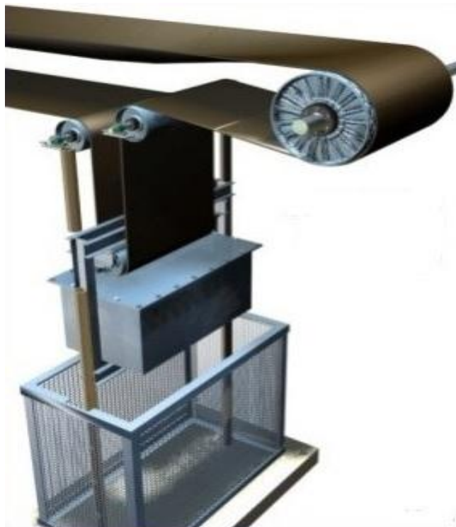
Obr. 1.3 Vertikální závažové napínací za ízení[8]
