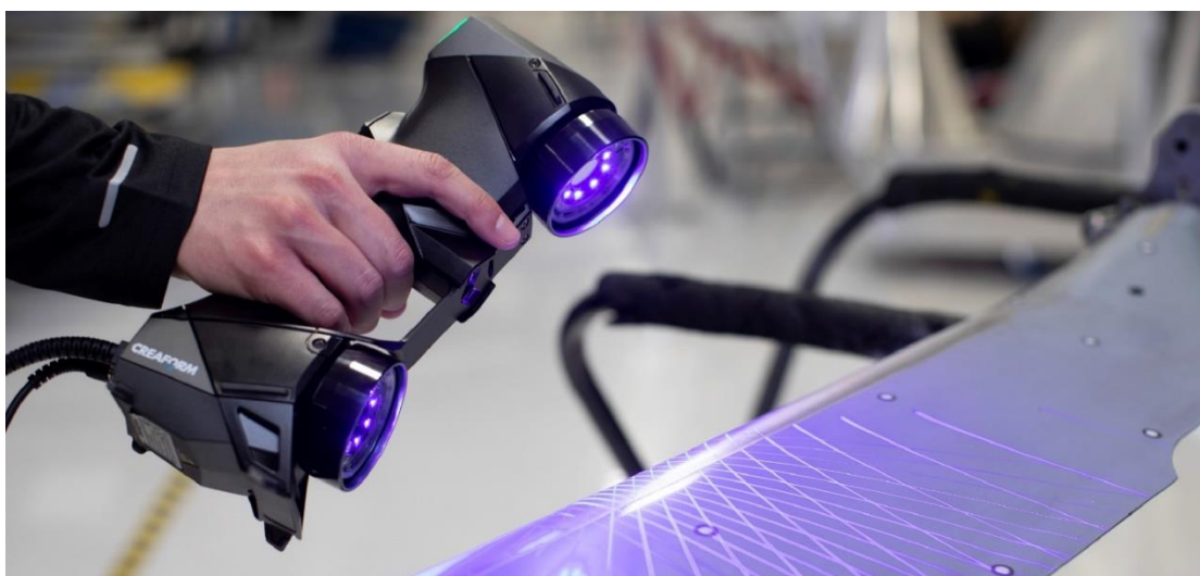
Obr. 2.26 Laserové skenovanie pomocou HandySCAN [28]
