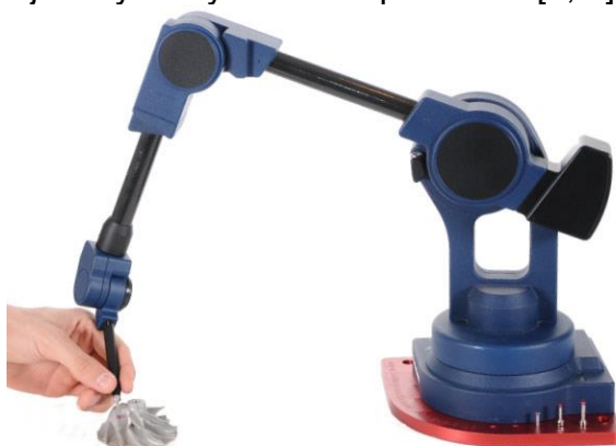
Obr. 2.9 3D ručný digitalizér MicroScribe [15]
