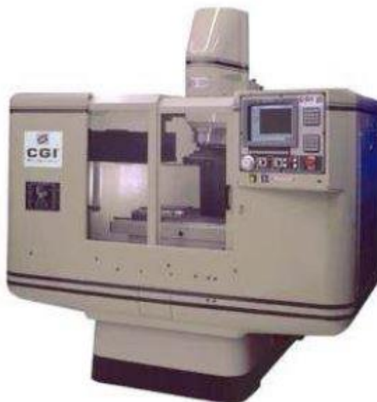
Obr. 2.7 Deštruktívny skener RE1000 [12]
