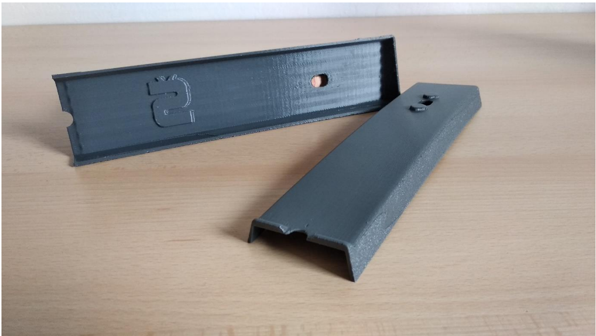
Obr. 4.20 Vytlačný master model metódou FDM
