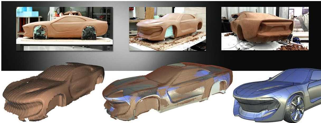
Obr. 1.5 Prevedenie hlineného modelu do digitálnej podoby [6]
