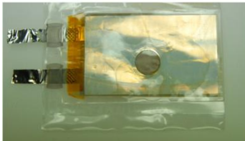
Obr. 1.10: Pouch in-situ cely (převzato z [21], upraveno)
