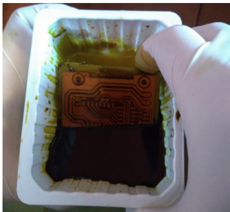
Obr. 2.26: Leptání roztokem FeCl 3
