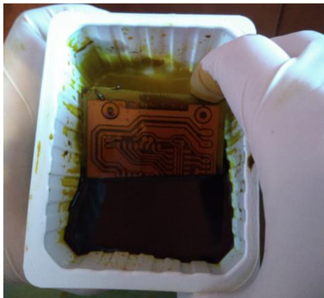
Obr. 2.26: Leptání roztokem FeCl 3
