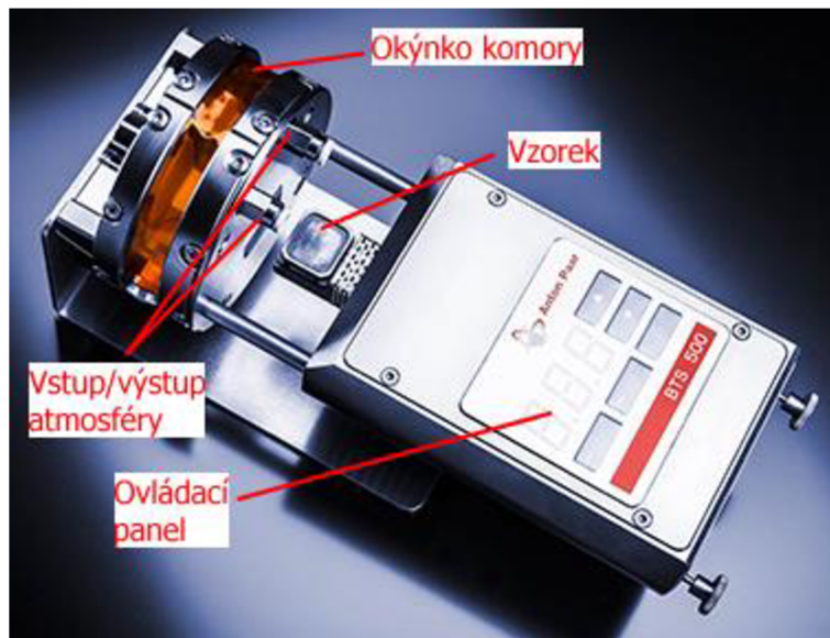
Obr. 1.8: In-situ cely s řízením teploty a atmosféry (převzato z [14], upraveno)
