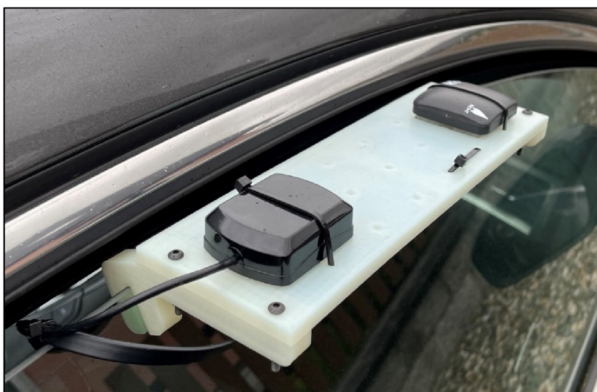
Obrázek 19: Montážní přípravek pro uchycení GNSS přijímačů; vhodná instalace antén
