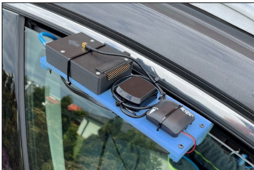
Obrázek 18: Montážní přípravek pro uchycení GNSS přijímačů; chybná instalace antén
