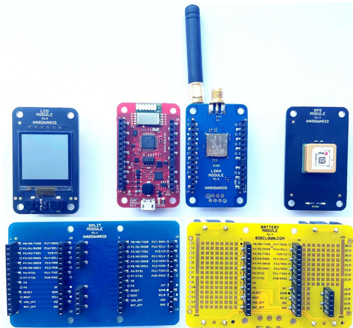
Obr. 33. Rozložená sestava všech HARDWARIO LoRa tester modulů
