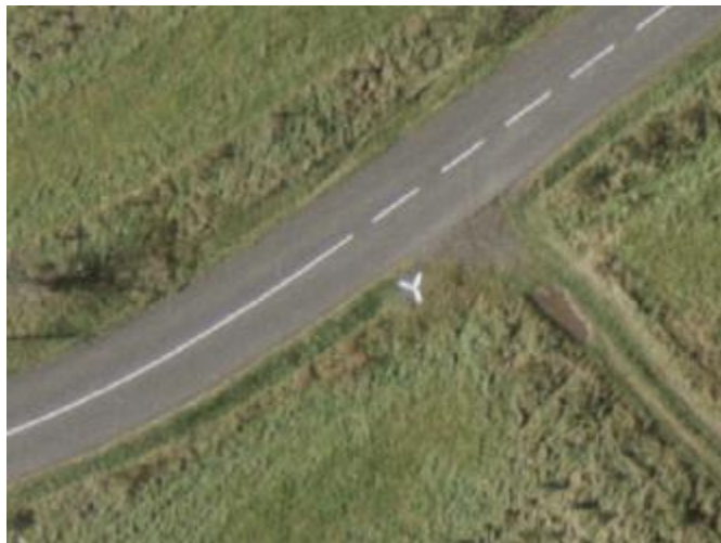
Obr. 11: Vlícovací bod v podobě trojramenného kříže
