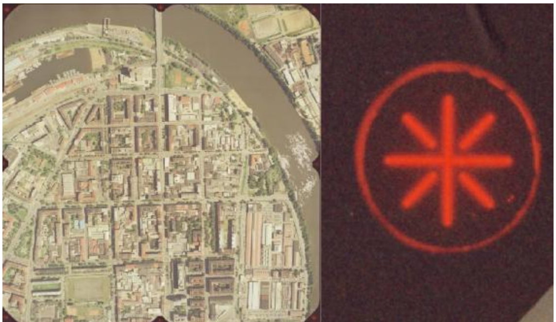
Ukázka leteckého snímku s osmi rámovými značkami, detail rámové značky (Gefos a.s., vlastní archiv, 2009)
