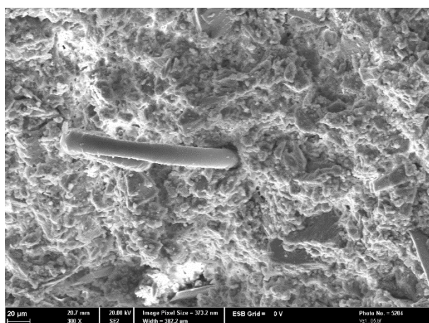
c) nylonová vlákna, elektronový mikroskop - původní zvětšení 300 x
