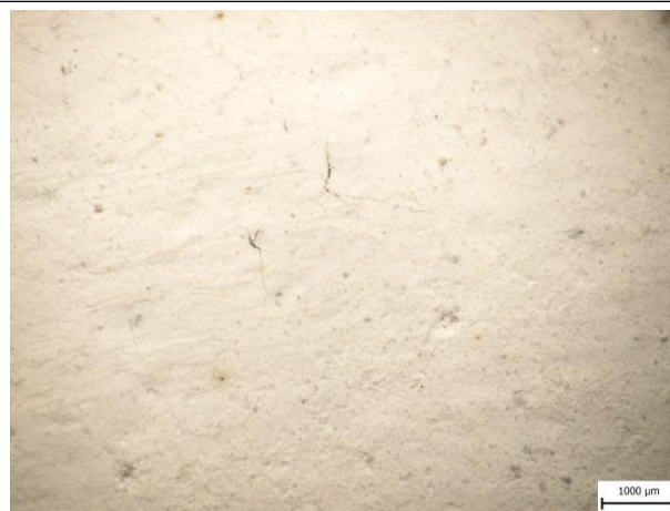
b) – čelo nezapáleného vzorku, původní zvětšení 40 x
