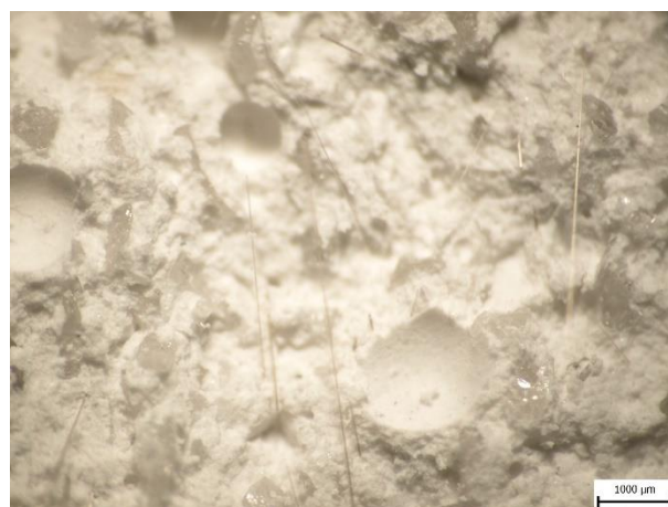
b) čedičová vlákna, stereomikroskop - původní zvětšení 44 x
