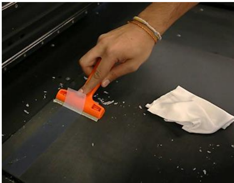
Obr. 1.1: Vyjmutí vytištěného dílu z tiskárny [4]
