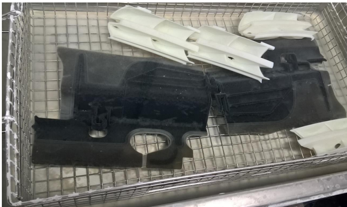
Obr. 4.17: Zkušební tělesa ponořená ve vysoce zásadité ultrazvukové lázni
