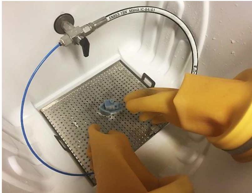
Obr. 1.2: Čištění vysokým tlakem vody [5]
