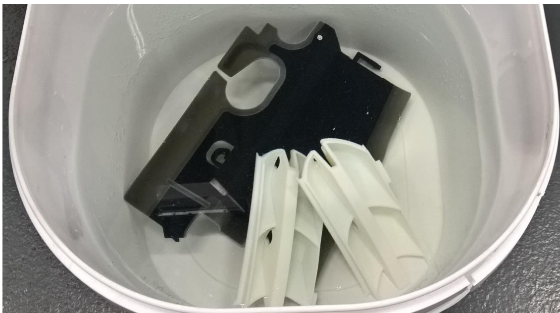
Obr. 4.19: Zkušební tělesa ponořená v neutralizační lázni glycerolu
