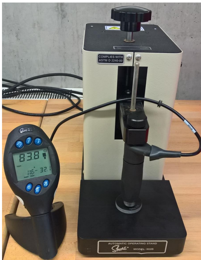
Obr. 4.5: Průběh stanovení tvrdosti materiálu na zařízení Shore® Durometer
