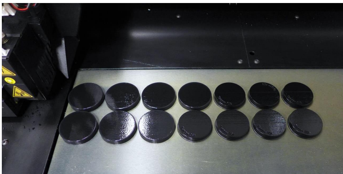
Obr. 4.2: Testovací tělesa vyrobená na zařízení Objet Connex 500
