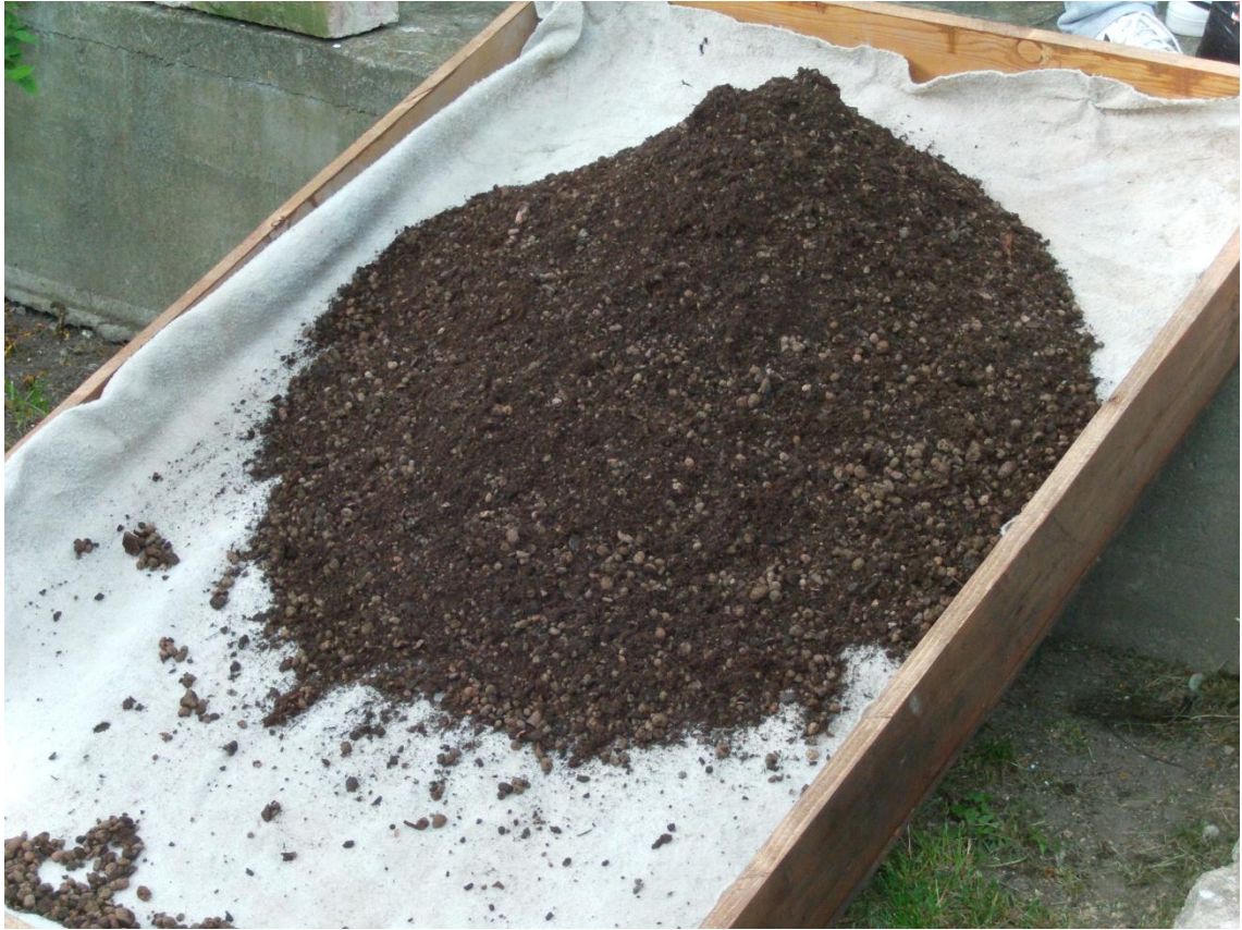
Obr. 14: Substrát pro střešní zahrady – extenzivní - SSE používaný na všech modelech extenzivních šikmých vegetačních střechech.
