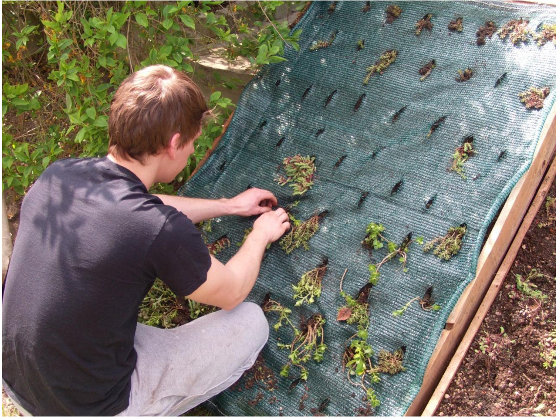
Obr. 17: Výsadba rozchodníků ( Sedum ) na modelu extenzivní šikmé vegetační střechy sklonitosti 35°.
