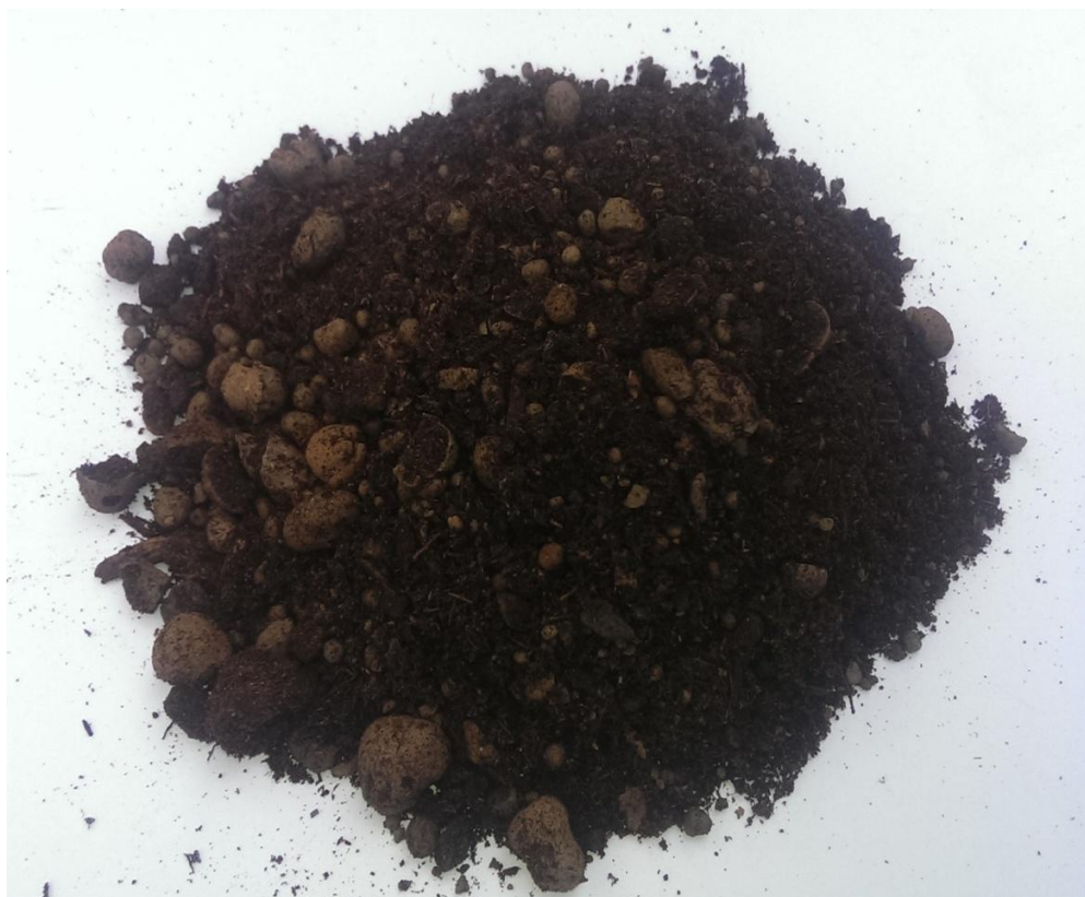
Obr. 2: Substrát pro střešní zahrady – extenzivní SSE, byl použit u všech modelů šikmých vegetačních střech i u gabionů.
