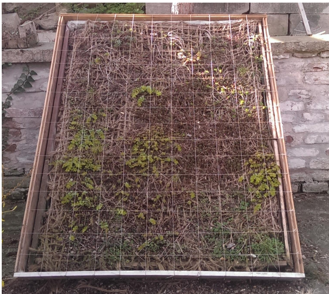
Obr. 21: Síťová konstrukce pro zjištění dynamiky růstu vegetace na modelu extenzivní šikmé vegetační střechy sklonitosti 55°.
