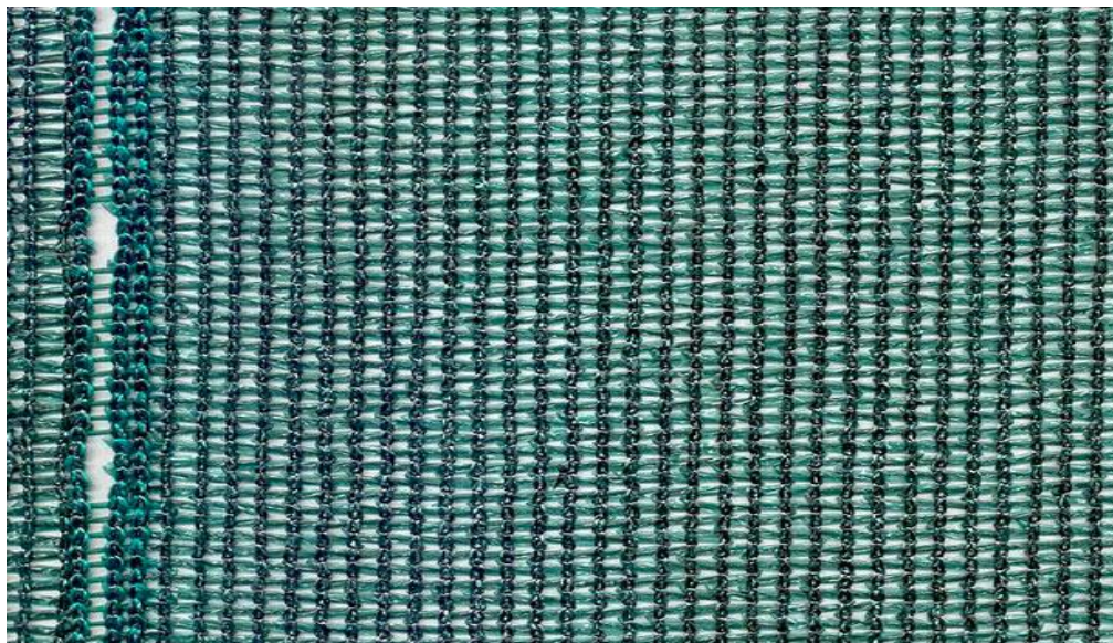
Obr. 3: Stínící rašlový úplet. Výrobce Juta a. s. ( www.juta-adamov.cz ).
