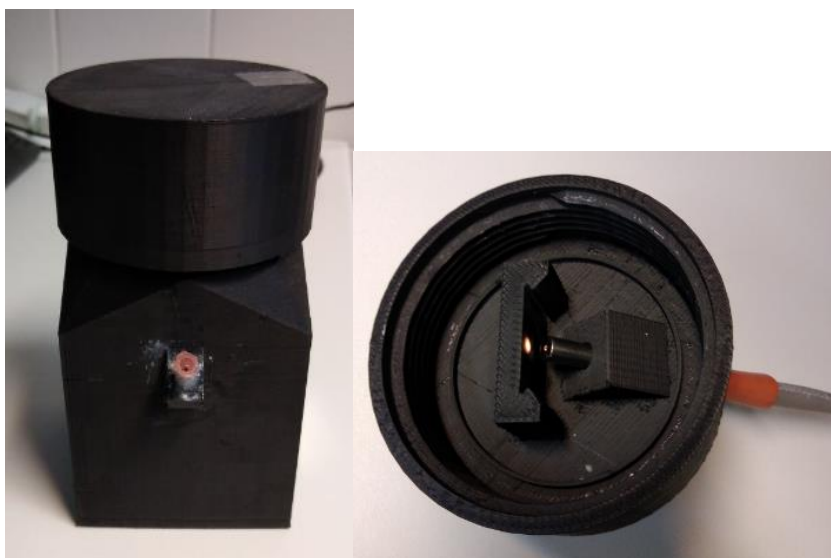
Obrázek 15: Speciální láhev a víčko s měřicí sondou
