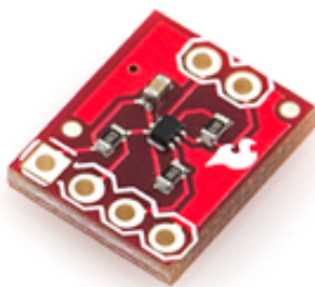
Obrázek 2.4: Senzor TMP102 převzato z [14]
