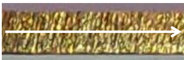
Obr. 35 Směr pohybu a umístění měřicího hrotu na testované ploše.
