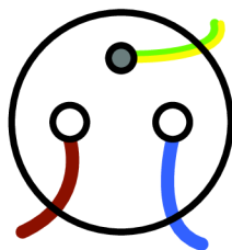
Obr. 1.1: Zapojení vodičů zásuvky typu E.
