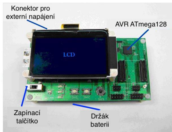
Obrázek 4.2: Popis modulu s displejem [6]
