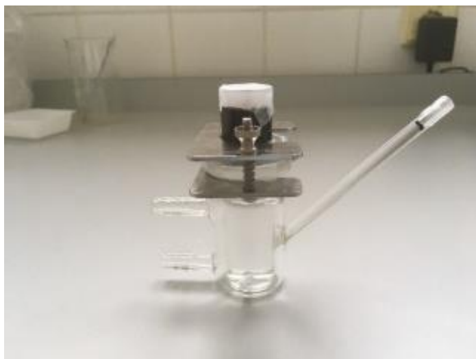
Obrázek 17: Franzova difuzní cela. v donorové části se nachází kyselý ibuprofen s lignohumátem o koncentraci 10 g/l
