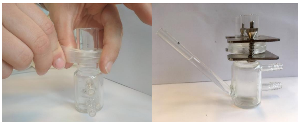
Obrázek 20: Mezera mezi oběma částmi aparatury obalena parafilmem (vlevo), následné upevnění pomocí svorky (vpravo)
