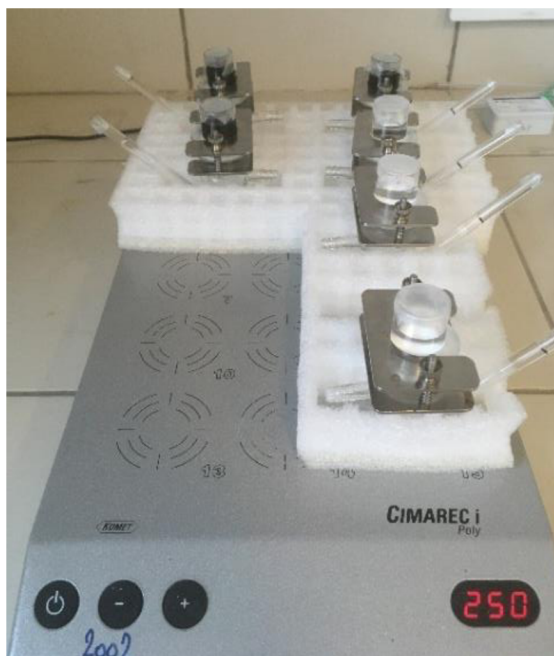
Obrázek 21: Cely se vzorky umístěné v boxech na vícemístném magnetickém míchadle
