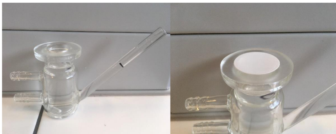
Obrázek 18: Roztok chloridu sodného s míchadlem v akceptorové části (vlevo), strat-M ® membrána položena lesklou stranou vzhůru (vpravo)
