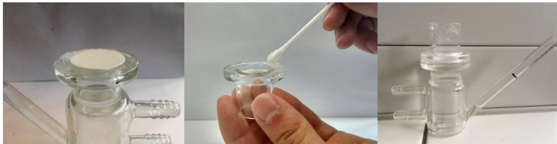
Obrázek 19: Styčná plocha akceptorové části natřená silikonovou pastou (vlevo), donorová část natřená silikonovou pastou (uprostřed), spojení donorové a akceptorové části (vpravo)
