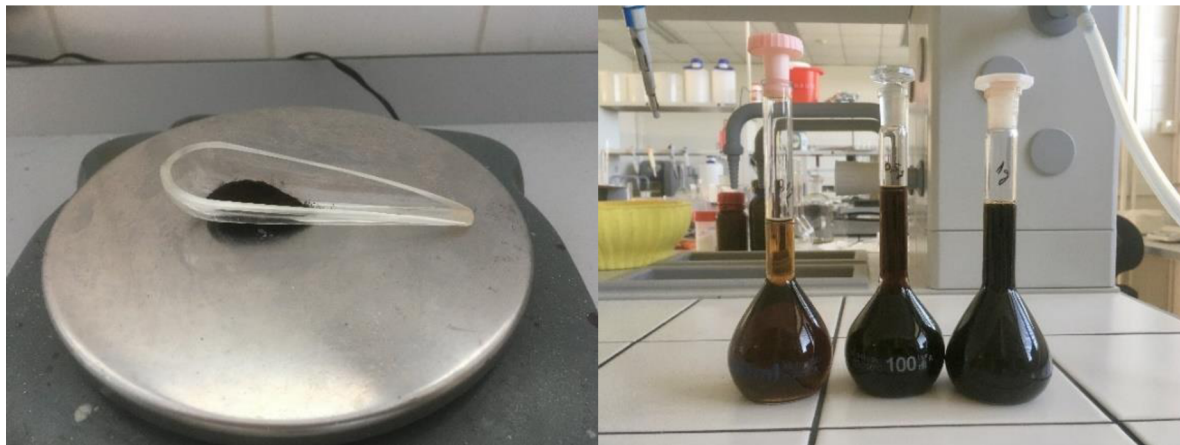
Obrázek 16: Navážka lignohumátu (vlevo), roztoky lignohumátu o koncentraci 1; 5; 10 g/l (vpravo)
