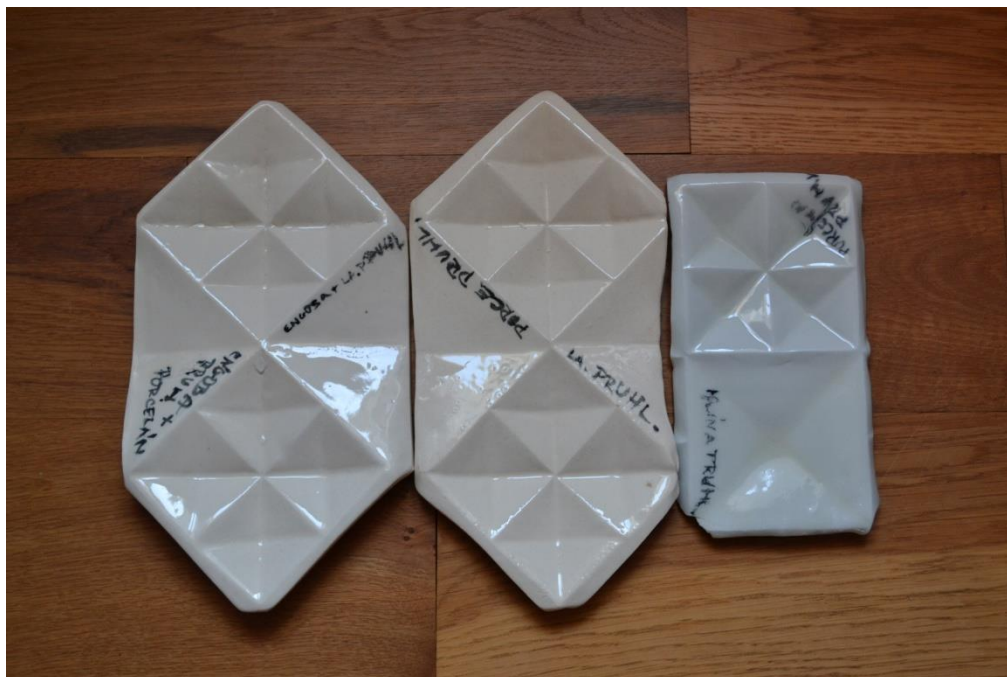
Obr. 30. Zkoušky glazur: 1. keramika, bílá engoba+průhledná glazura, 2. keramika, průhledná glazura, 3. porcelán, průhledná glazura
