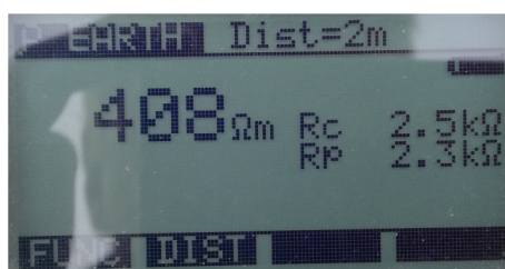
Obr. 6.5: Príklad výsledku z merania rezistivity pôdy EUROTTEST 61557
