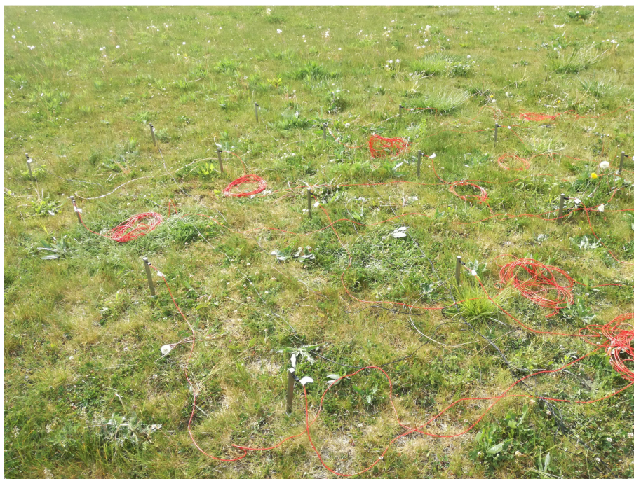
Obr. H.1: Rozloženie elektród pri prebiehajúcom meraní v teréne
