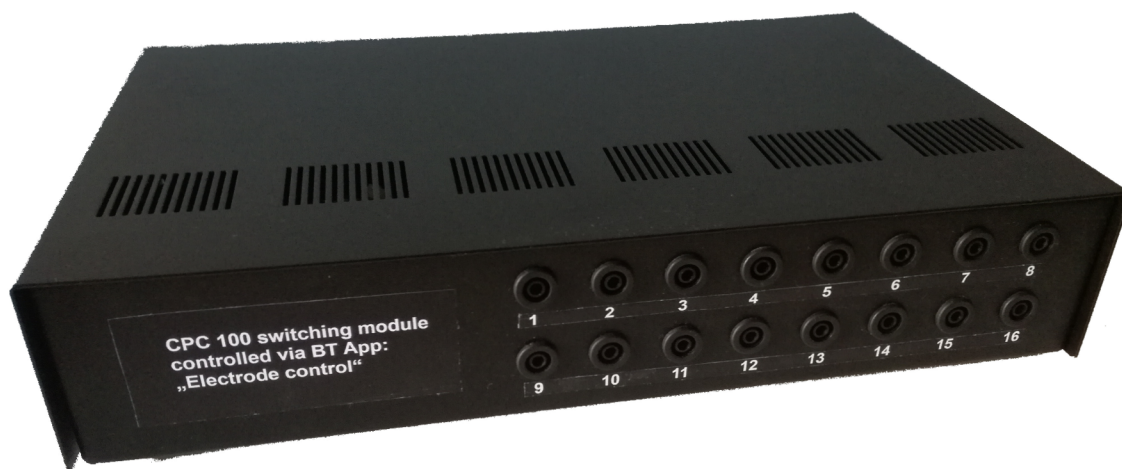
Obr. 7.12: Pohľad na vyhotovené zariadenie pre plošné meranie \rho pôdy
