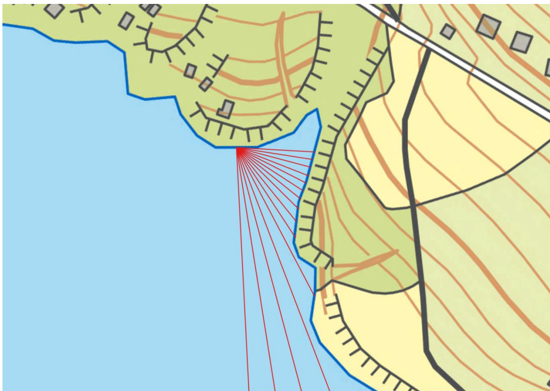
Obrázek č. 13 Detail schématu k výpočtu efektivní délky rozběhu větru L_{ef}
