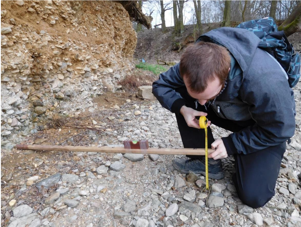
Fotografie č. 6 Měření sklonu abrazní plošiny v terénu
