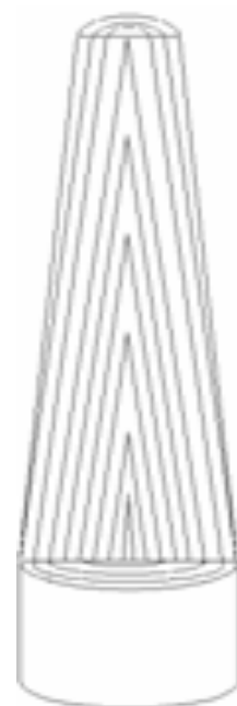
Obr. 11 Valcovo-kuželovitá stavba dreva [7]
