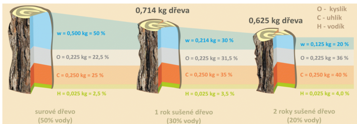
Obr. 5 Prirodzené sušenie dreva [19]
