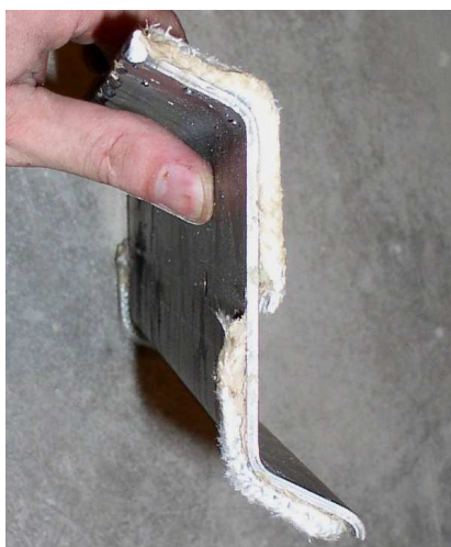
Obr. V - Středová klapka usměrňující spaliny.
