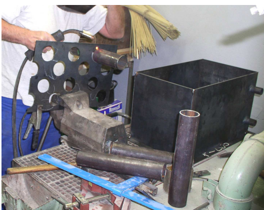
Obr. V - Sváření vodní přepážky a vymezení vůlí žárových trubek.
