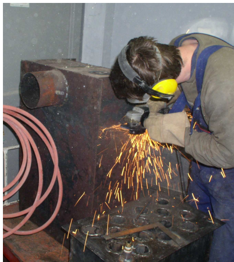
Obr. I - Odřezání kouřové komory.
