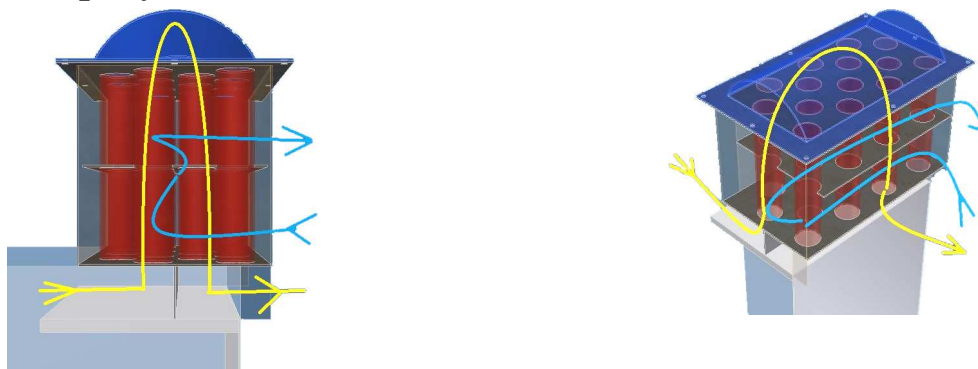
Obr. IV - Spaliny a voda prochází skrz výměník ve vyznačených směrech (tento koncept byl vybrán jako nejefektivnější a proto byl realizován).
