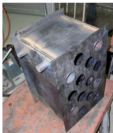
Obr. VI - Svařenec pláště výměníku.
