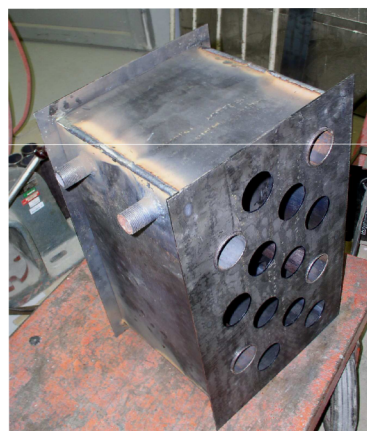
Obr. VI - Svařenec pláště výměníku.
