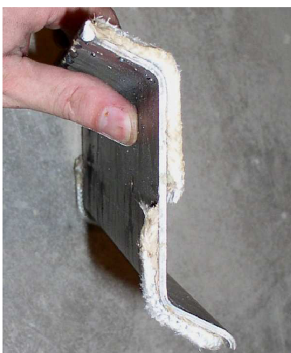
Obr. V - Středová klapka usměrňující spaliny.
