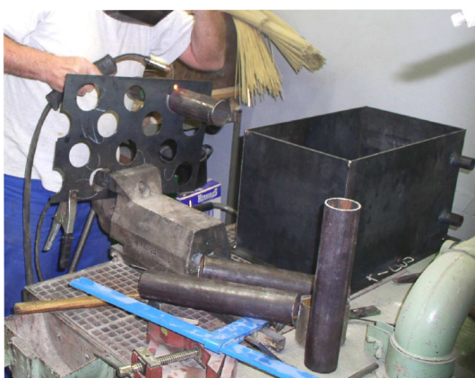
Obr. V - Sváření vodní přepážky a vymezení vŕlů žárových trubek.
