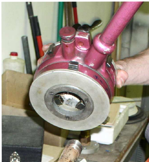
Obr. I - Řezání závitu závitovou hlavou (pro připojení otopné vody).
