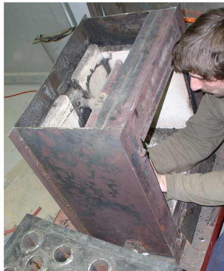
Obr. II - Kamna bez kouřové komory.
