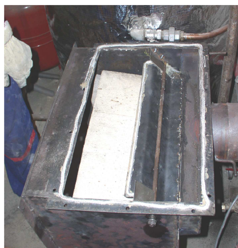
Obr. VI - Zaizolování středové klapky.
