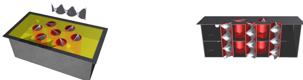
Obr. II - Spaliny prochází skrz výměník pouze směrem vzhůru a jsou zavířeny turbulátory. (u tohoto konceptu by byla dosažena největší rychlost spalin na teplosměnných plochách)
