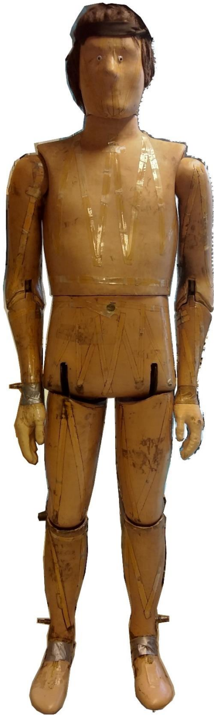
Figure 15a. Tore – Dry thermal manikin
