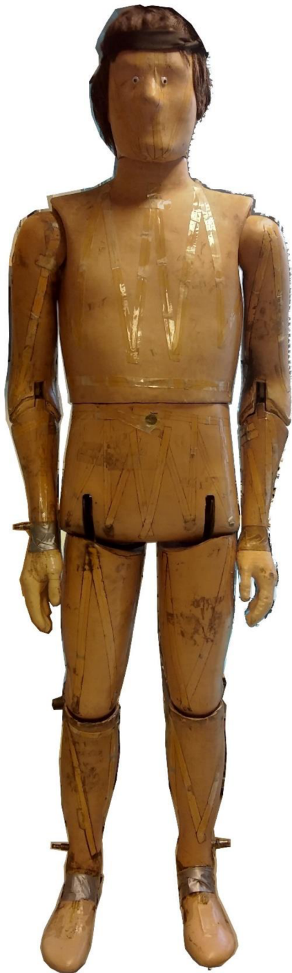
Figure 15a. Tore – Dry thermal manikin
