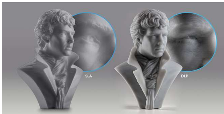
Obrázek 12: SL vs DLP 3D tisk [14]
