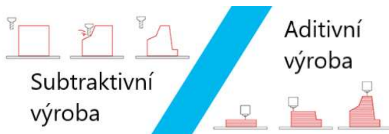
Obrázek 3: Aditivní a subtraktivní výroba [3]
