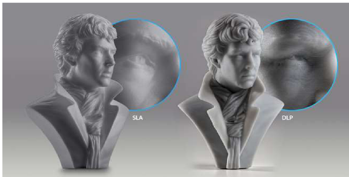
Obrázek 12: SL vs DLP 3D tisk [14]
