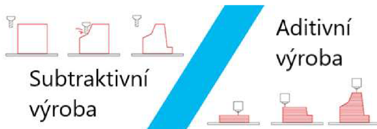
Obrázek 3: Aditivní a subtraktivní výroba [3]
