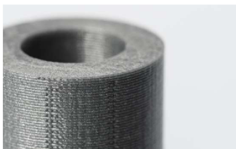
Obrázek 6: Část vytvořená procesem FDM [6]
