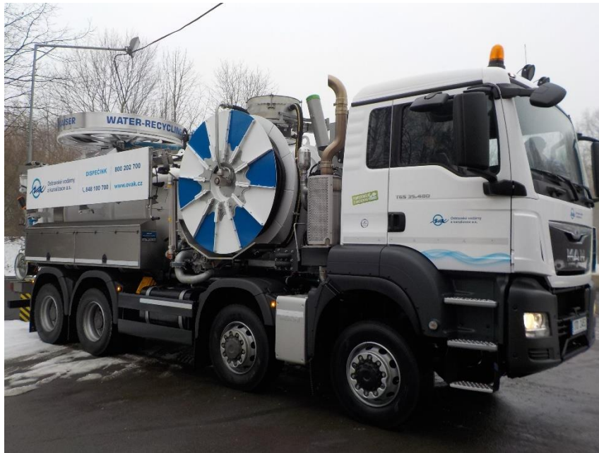
Obr. 23 Čistící vozidlo KAISER Aquastar III [30]
