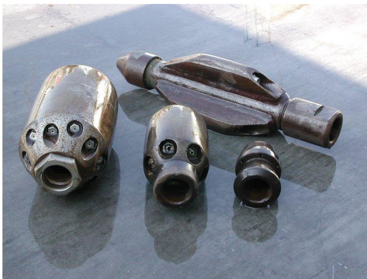
Obr. 4 Hlavice čistících trysek [5]
