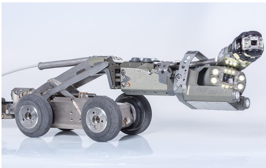
Obr. 5 Satelitní kamerový systém Rausch M 200 [7]
