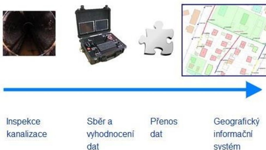
Obr. 6 Schéma principu exportního modulu ISYBAU XML [9]
