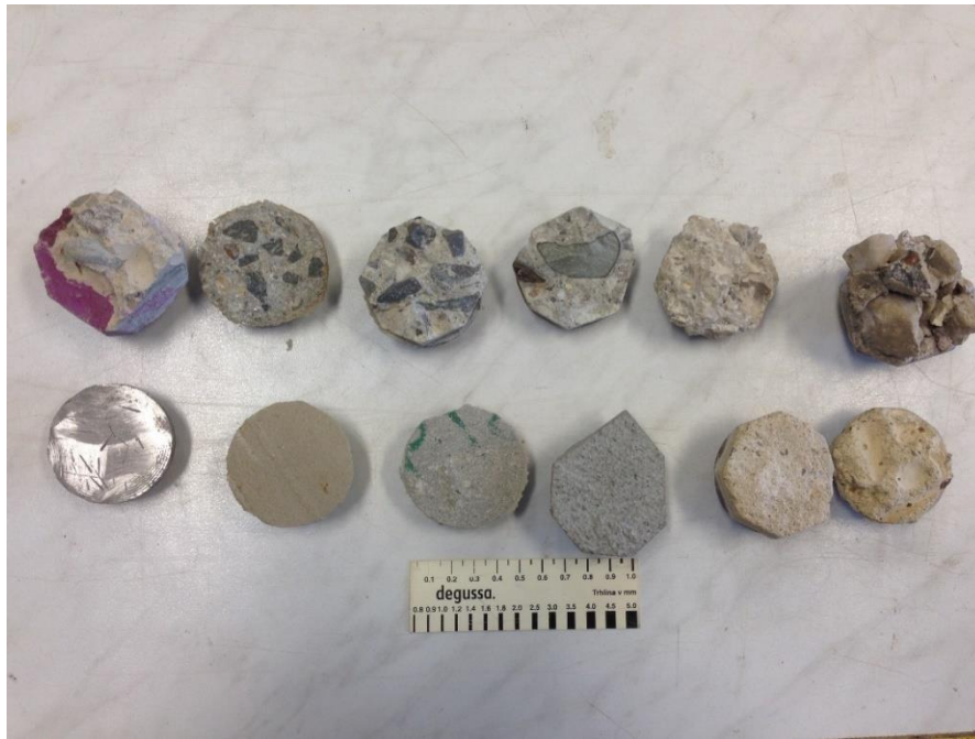
Obr. 11 Ukázka výsledků odtrhových zkoušek [L. Židek]
