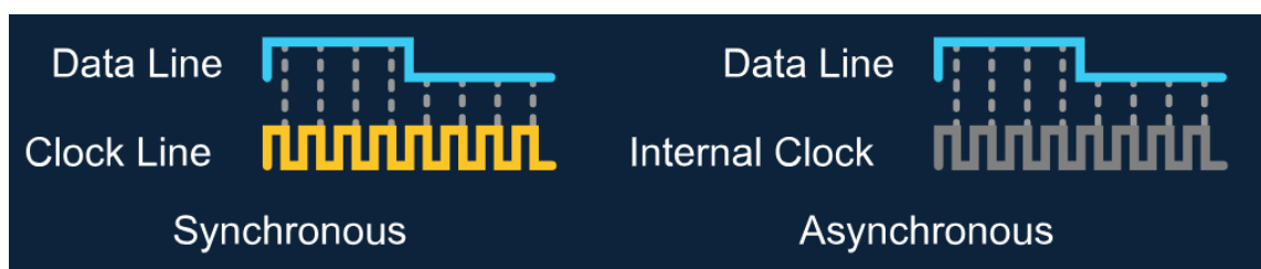
Obrázek 2.6: Synchronní vs Asynchronní sériová komunikace [10]
