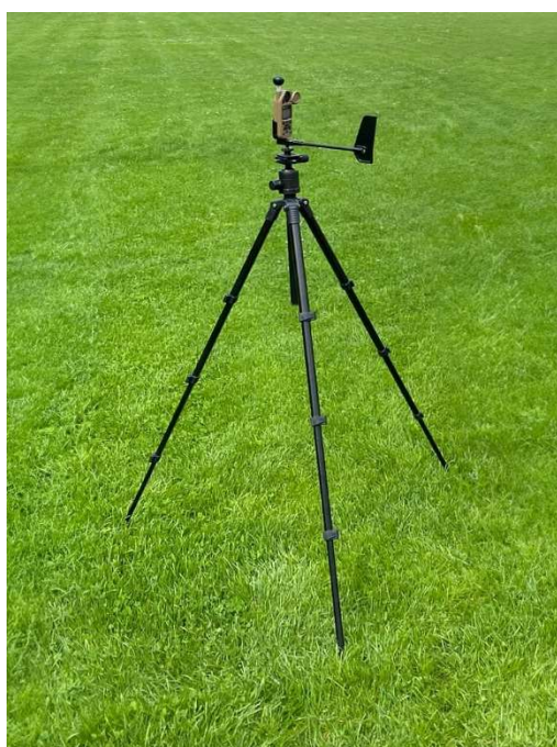
Obrázek 4a: přístroj na měření teploty (Kestrel)
