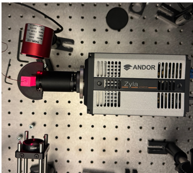
Obrázek 7.8: Kamera snímající rozptýlené světlo ze vzorku
