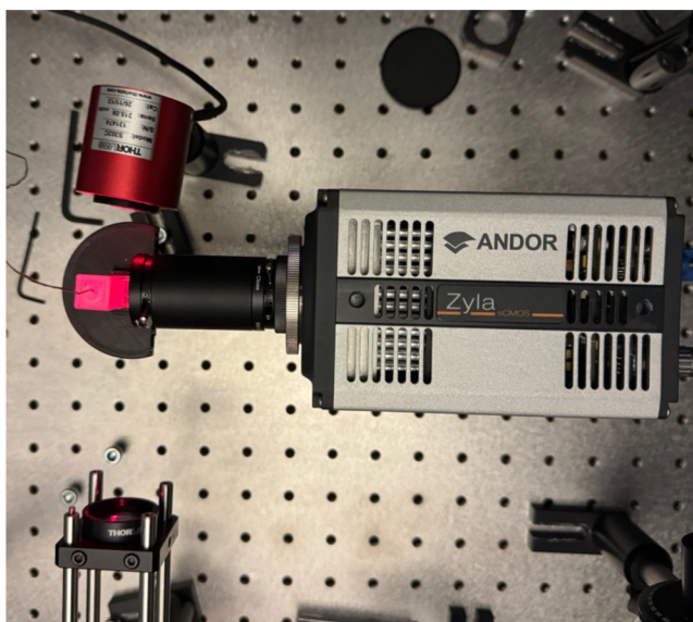
Obrázek 7.8: Kamera snímající rozptýlené světlo ze vzorku
