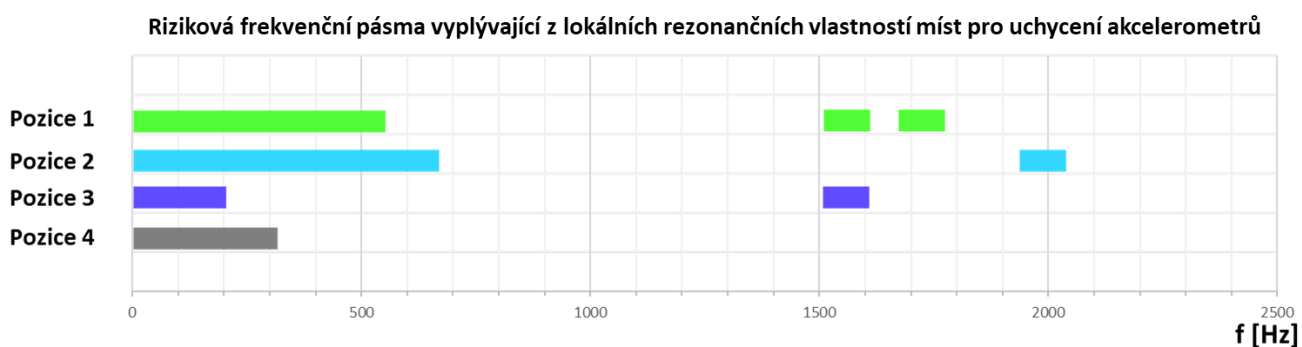
Obr. 8.31 Graf s vyznačenými rizikovými frekvenčními pásmy v pozicích umístění akcelerometrů
