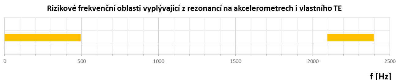
Obr. 8.42 Rizikové frekvenční oblasti PST-TE vyplývající ze zkoušek rozběhu (i doběhu) v uspořádání napřímo a v kompletním uspořádání
