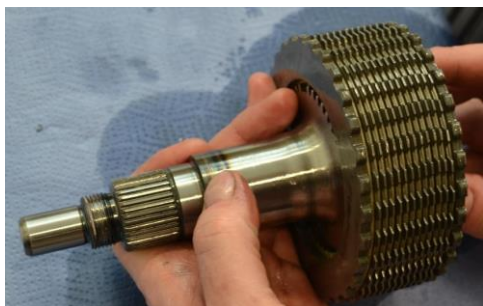
Obr. 8.10 Uspořádání lamel v systému Haldex
