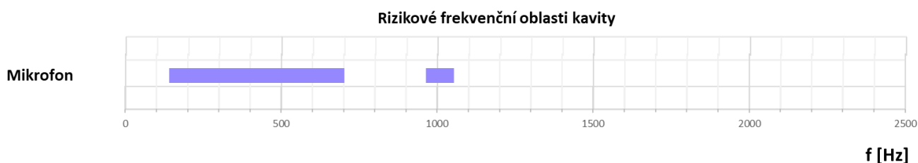
Obr. 8.45 Rizikové frekvenční oblasti pramenící z rezonančních vlastností kavity
